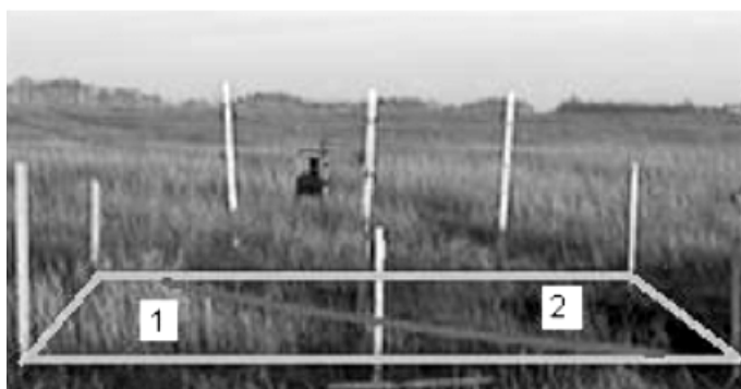
Рис. 9 – Результаты эксперимента по распространению фронта горения от линейного источника зажигания, расположенного вдоль направления скорости ветра. 1 – зона несгоревшего СГМ, 2 – зона, где распространялся фронт горения под действием ветра
