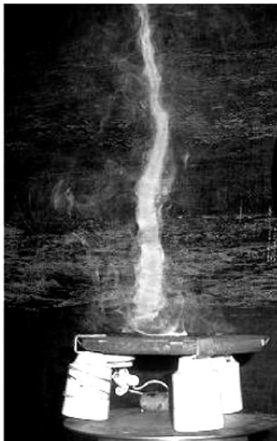
Рис. 3. Фотография теплового смерча при закрутке нижнего основания
