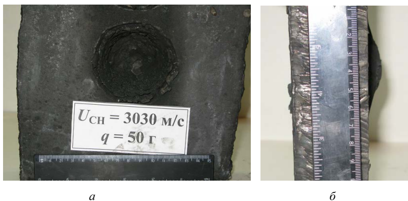
Рис. 9. Вид лицевой (а) и боковой (б) поверхностей бронеплиты после соударения с ударником с сердечником из стали
