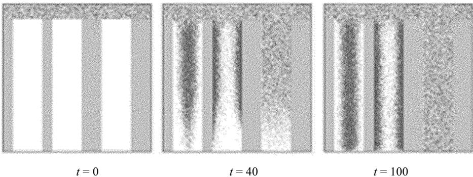
Рис. 1. Три глобальных состояния фрагмента пористой мембранны при моделировании прохождения пара через гидрофобную, гидрофильтрующую и нейтральную поры
