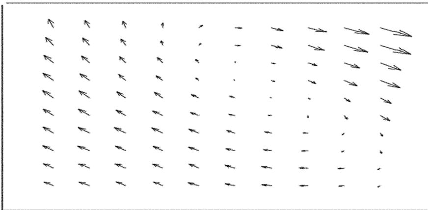
Рис. 3. Фрагмент проекции на продольный разрез трубы поля скоростей за задвижкой, полученный путем применения библиотеки MathCad к результату моделирования потока в трубе с помощью КА-модели RD-1
