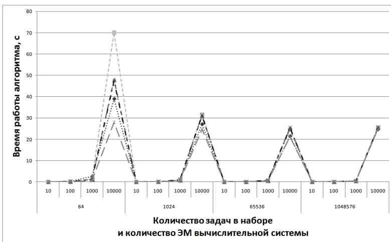
Рис. 2. Влияние  $e$  на время работы последовательного ГА ( $STEPS_{GA} = 5$ ,  $PS_{GA} = 32$ ,  $P_{GA} = 0,8$ ):  $\cdots\bullet\cdots$  –  $e = 0,5$ ; –■– –  $e = 0,7$ ; –▲– –  $e = 0,8$ ; –×– –  $e = 0,9$ ; –\*– –  $e = 1$
