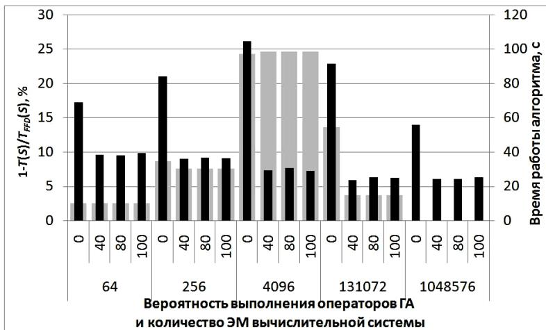
Рис. 4. Влияние вероятности выполнения операторов кроссинговера и мутации на качество работы ГА ( $L = 10000$ ,  $PS_{GA} = 32$ ,  $e = 0,95$ ): ■ – улучшение значения функции  $T(S)$ , %; ■ – время работы алгоритма, с
