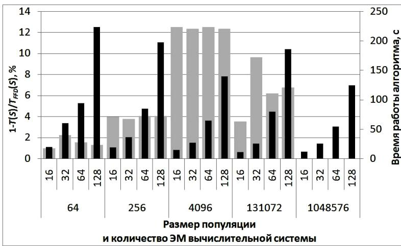
Рис. 3. Влияние размера популяции  $PS_{GA}$  на качество работы ГА ( $L = 10000$ ,  $STEPS_{GA} = 5$ ,  $P_{GA} = 0,8$ ,  $e = 0,95$ ): ■ – улучшение значения функции  $T(S)$ , %; ■ – время работы алгоритма, с
