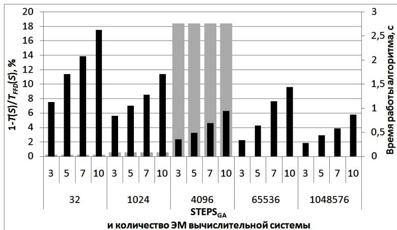
Рис. 1. Влияние параметра  $STEPS_{GA}$  на качество работы последовательного ГА ( $L = 1000$ ,  $PS_{GA} = 32$ ,  $P_{GA} = 0,8$ ,  $e = 0,95$ ): ■ – улучшение значения функции  $T(S)$ , %; ■ – время работы алгоритма, с
