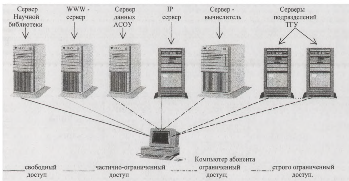
Рис. 1. Логическая схема доступа абонента сети TSUNet к ее информационно-вычислительным ресурсам
