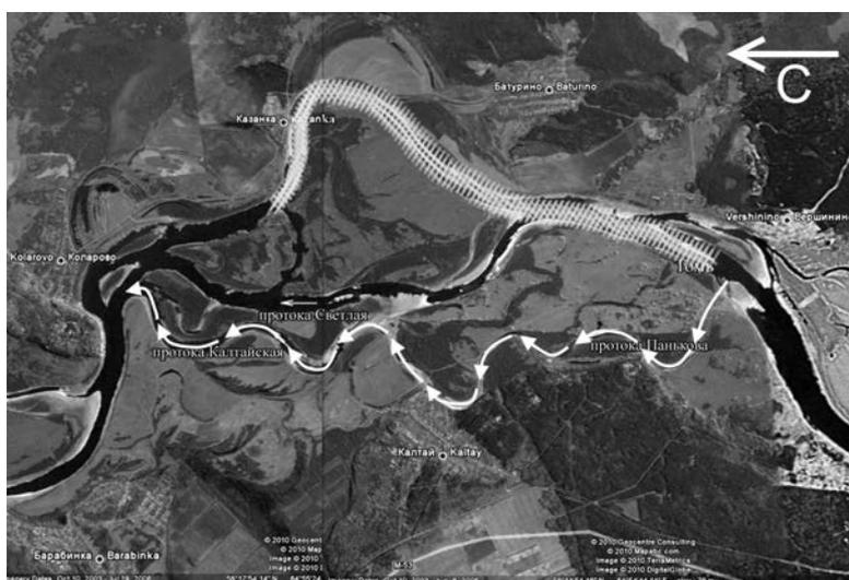
Рис. 6. Одна из характерных схем возникновения затора (затор обозначен штриховкой) и направления основного стока воды (обозначены стрелками) на рассматриваемом участке
