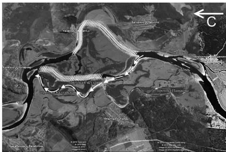
Рис. 5. Одна из характерных схем возникновения затора (затор обозначен штриховкой) и направления основного стока воды (обозначены стрелками) на рассматриваемом участке
