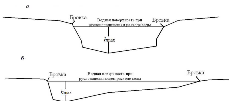
Рис. 1. Схема для определения положения бровок русла на участках с разным типом руслового процесса [7]
