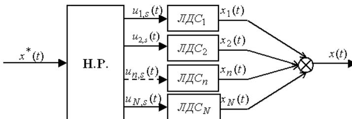
Рис. 2. Разомкнутая схема управления многомерным объектом, где Н.Р. – непараметрический регулятор
